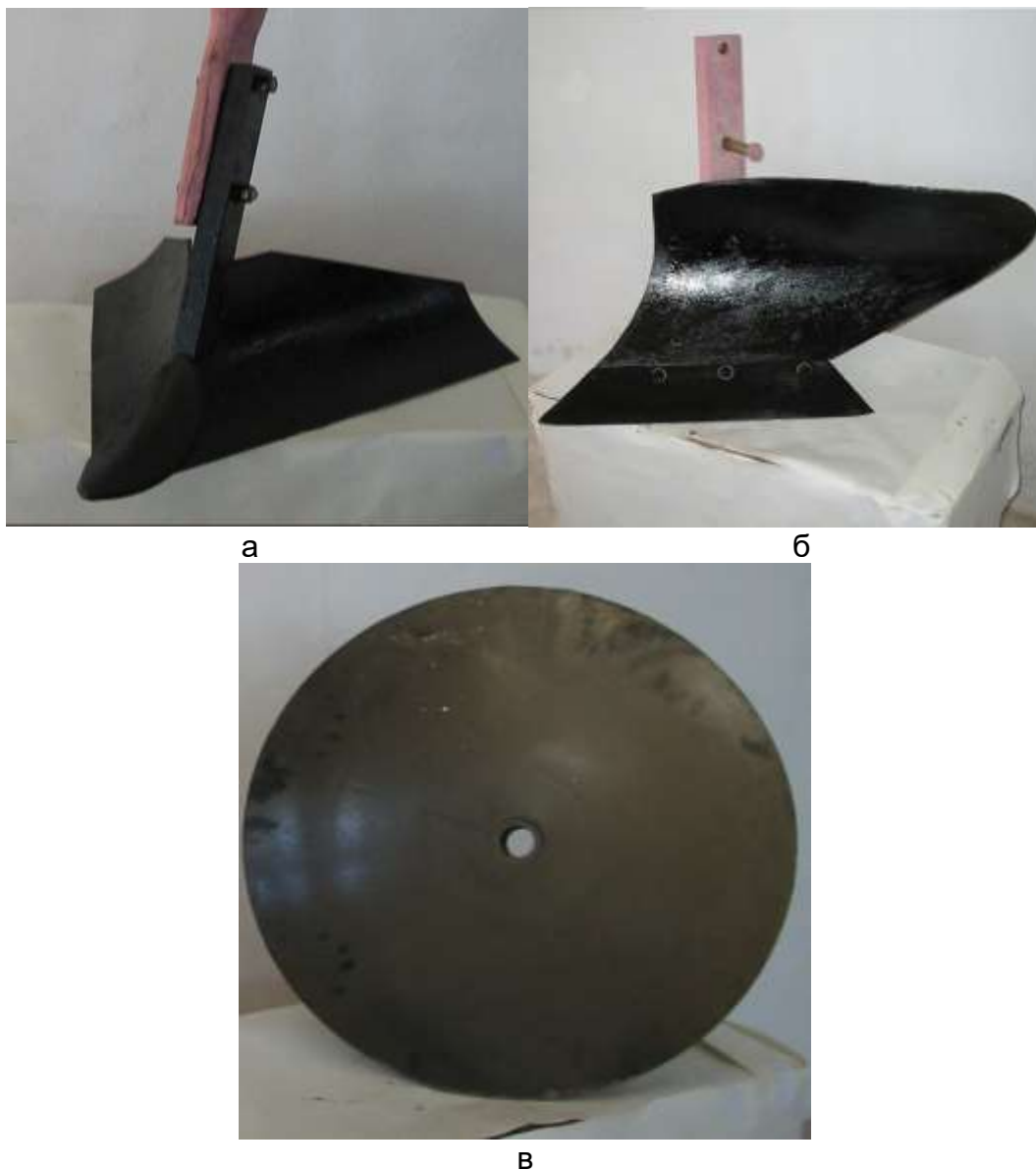
а-ГХ-4 пушта олгичнинг иш органи; б-ПД-4-45 икки ярусли плугнинг юқори корпуси в-ТДБ-3/5 дискали боронанинг сферик диски 1-расм. Пушта олгичнинг турли вариантлари
